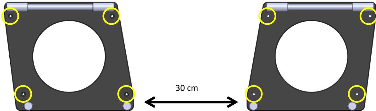
4. Verwenden Sie den Bleistift, um die Bohrlöcher durch die Löcher in der Grundplatte an der Wand zu markieren.
