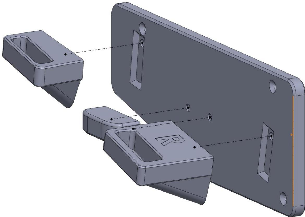
2. **Hinweis:** Die Schrauben werden direkt in den Kunststoff geschraubt. Achten Sie darauf, das Gewinde nicht durchdrehen zu lassen, um eine sichere Befestigung zu gewährleisten.
