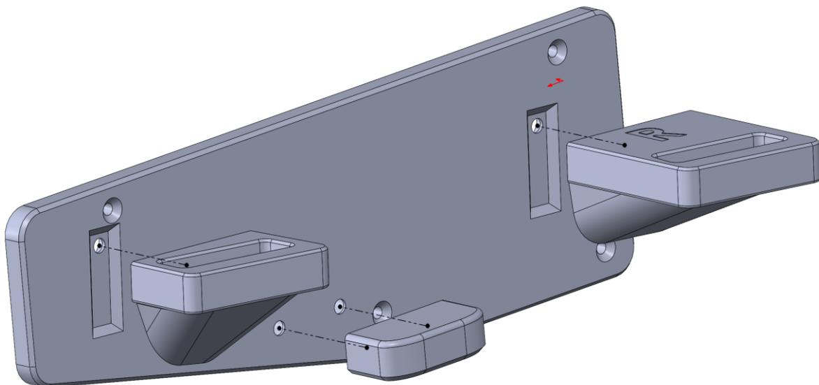
2. **Hinweis:** Die Schrauben werden direkt in den Kunststoff geschraubt. Achten Sie darauf, das Gewinde nicht durchdrehen zu lassen, um eine sichere Befestigung zu gewährleisten.
