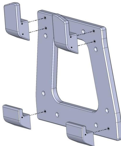
2. **Hinweis:** Die Schrauben werden direkt in den Kunststoff geschraubt. Achten Sie darauf, das Gewinde nicht durchdrehen zu lassen, um eine sichere Befestigung zu gewährleisten.
